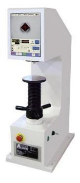
**Model Name** LD 250 HARDNESS TESTER (UNIVERSAL ROCKWELL-VICKERS – BRINELL)
